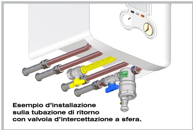
**Esempio d'installazione sulla tubazione di ritorno con valvola d'intercettazione a sfera.**
