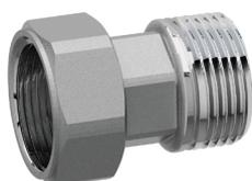
Il raccordo di giunzione M-F da 3/4" in ottone cromato con calotta mobile **art.8323 34** consente la connessione con attacco femmina da 3/4" direttamente a parete sull'uscita della tubazione di ritorno.
